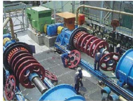
Hình 2. Hệ thống khuấy trộn của máy nghiền IsaMill
