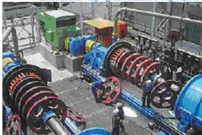
Hình 2: Hệ thống khuấy trộn của máy nghiền IsaMill
