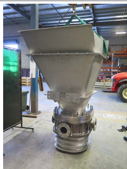
Порт подачи питания с принудительной тягой до установки
